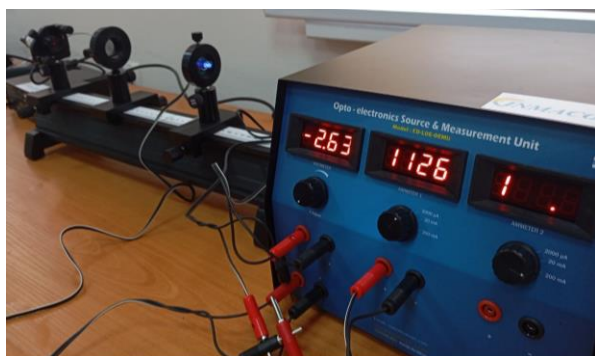
3-rasm. Yorug'lik diodining volt-amper xarakteristikasini aniqlash.
