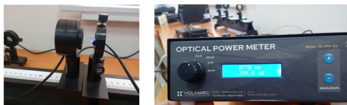
6-rasm. LED diodidan yorug'lik chiqishi va uning quvvati.
