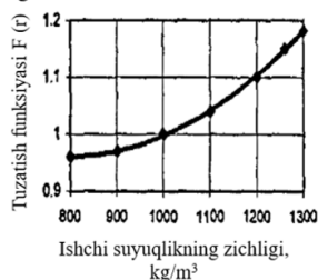
4-rasm. Tuzatish funksiyasi F(\rho) ning ishchi suyuqlik zichligiga bog'liqligi
