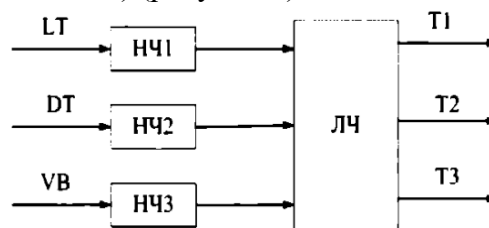
Рисунок 3 - Структура модели Гаммерштейна Нелинейная часть аппроксимирована кубической параболой:
