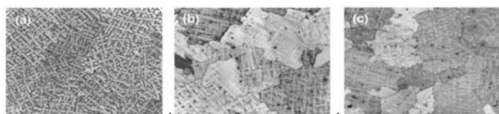
1-rasm. Marganes po'latining mikro tuzilishi. a – 1-na'muna, b – 2-na'muna, c – 3-na'muna.
