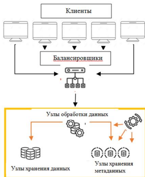
Рис.5 Схема работы простого хранилища S3
