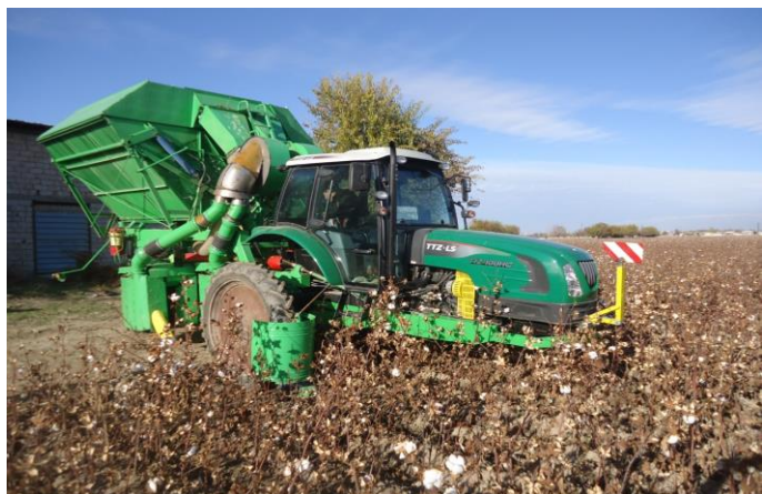
Рис. 1. Хлопкоуборочная машина с установленными видеокамерами на хлопковом поле.
