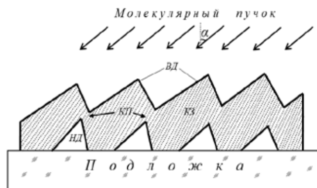
Рис.1.Схематическая модель косонапыленной поликристаллической пленки, выращенной на стеклянной подложке: ВД – верхние дендриты, НД – нижние дендриты, КЗ – кристаллическое зерно, КП – канал протекания.
